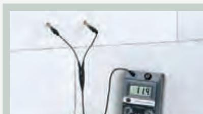
**ANWENDUNG** Messung mit einem Tiefen-Messelektrodenpaar M 21-250
