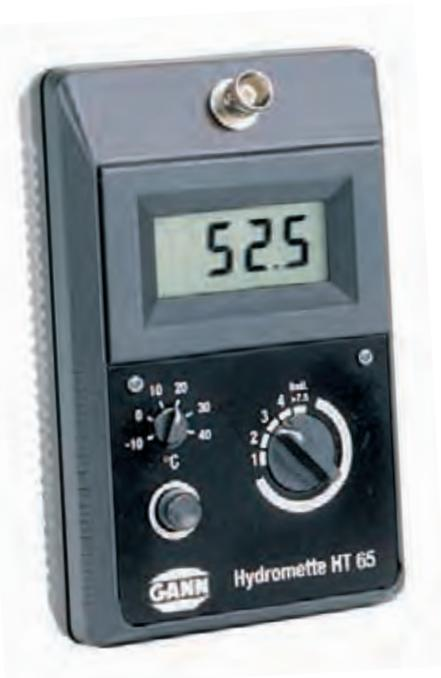
Die HT 65 ist ein elektronischer **Holzfeuchtemesser** nach dem Widerstands-Messprinzip für Präzisionsmessungen von **Schnittholz** (bis 180 mm Stärke), **Spanplatten**, **Furnieren** sowie **Hackschnitzeln** und ähnlichen Schüttgütern durch Einzelmessungen vor und nach der Verarbeitung.
