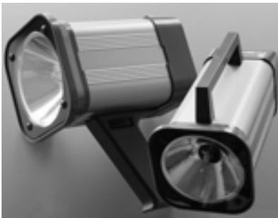
Die Stroboskope der Baureihe SMS-300 können handgeführt oder auf einem Stativ montiert zur Beobachtung von sich wiederholenden Bewegungsabläufen sowie zur Frequenz- und Drehzahlermittlung an Maschinen und Anlagen und deren Antriebselemente eingesetzt werden. Sie machen schnell transportiertes, kontinuierlich bewegtes Material ebenso sichtbar, wie Prozesse, die ansonsten mit dem Auge aufgrund der hohen Geschwindigkeit nicht wahrgenommen werden können.
