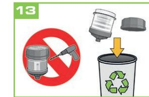
13 Entsorgen Sie die restlichen Kunststoffteile entsprechend örtlicher Vorschriften für die Mülltrennung. Der Schmierstoffgeber darf nicht aufgeschnitten, aufgebohrt oder wiederverwendet werden.
