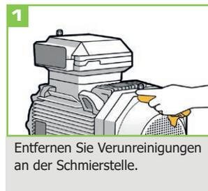
1 Entfernen Sie Verunreinigungen an der Schmierstelle.
