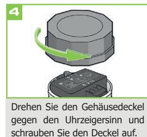
4 Drehen Sie den Gehäusedeckel gegen den Uhrzeigersinn und schrauben Sie den Deckel auf.
