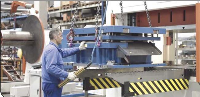
Das Verladen eines Werkzeuges mittels eines Gabelstaplers direkt auf einen Tisch ist sehr gefährlich. Mittels eines Krans ist es ganz unmöglich. Die Konsolen ermöglichen das sichere Verladen eines Werkzeuges mit Hilfe eines Krans oder eines Gabelstaplers in sicherem Abstand und den sicheren Transport auf den Pressentisch.
